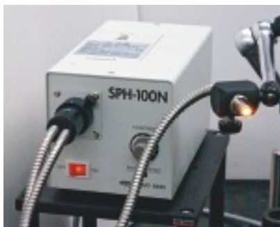
(a) ハロゲンランプ，光ガイド および照射ヘッド
