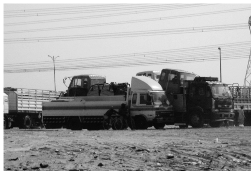
写真8 トラックの荷台にボディを載せてある。このままコンテナの中に入れて、周りのスペースに部品を詰め込むと再輸出用コンテナができる。
