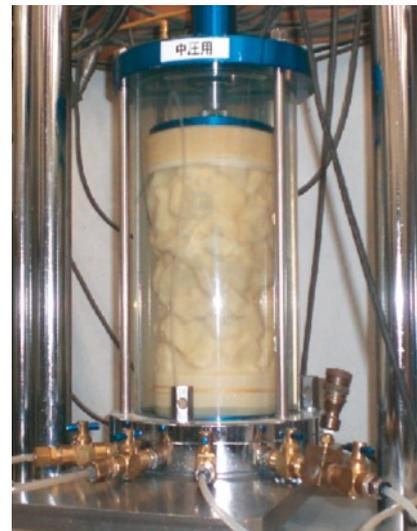
図-11 圧密排水 (CD) 三軸圧縮試験
