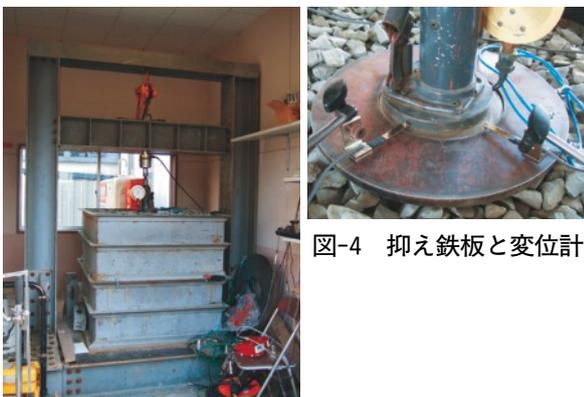
図-4 抑え鉄板と変位計
