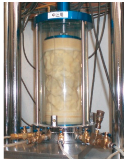
図-11 圧密排水 (CD) 三軸圧縮試験
