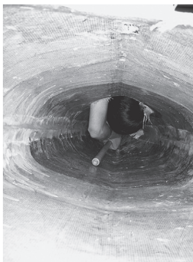
写真－12 ハル～デッキの継目内貼り
