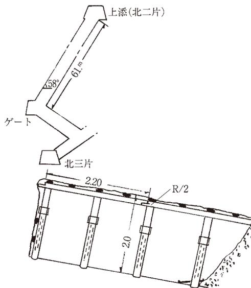
3. 鉄化計画は鉄柱で天盤を支え，右の図の構造となる。
