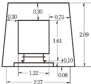
水平人車の運行制限は特段になく、石則第 251 条にいう(イ)側壁との間隔の幅を 0.75 m 以上、その他を 0.30 m 以上にすること、(ロ)人車の上ふたと天井、又は障害物との間隔 0.30 m 以上という内容に基き、全線 2000 m 中、木柵部分約 580 m について実地に検討して見た結果、拡大或は切上げを要する部分 100 m を有して居るが大仰な工数に依る拡大ではなく、布木並に脚の折損に依る仮
