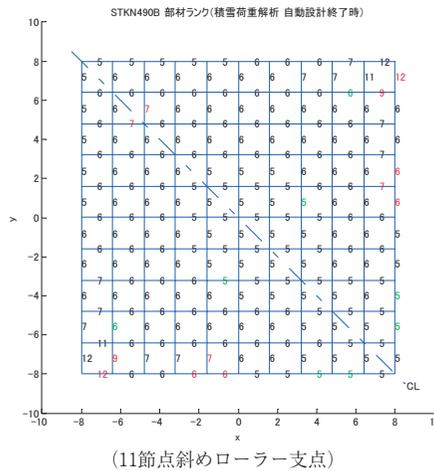
図4.19 STEP 1 断面設計終了時部材ランク
