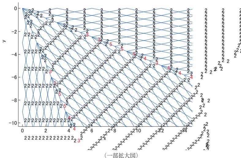
図4.26 STEP 1 断面設計終了時部材ランク
