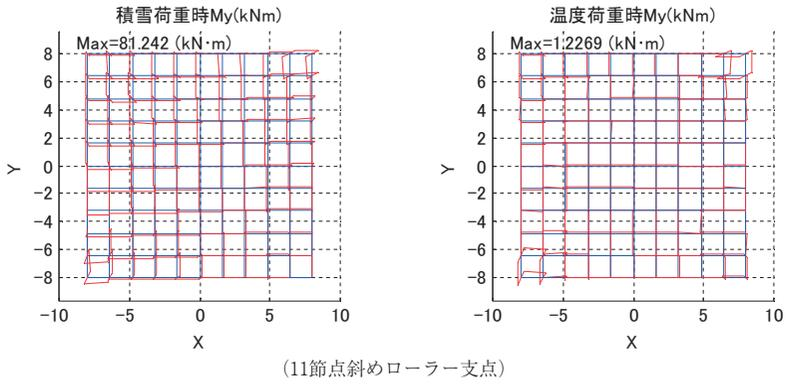
図4.22 積雪荷重時 (左), 温度荷重時 (右) My
