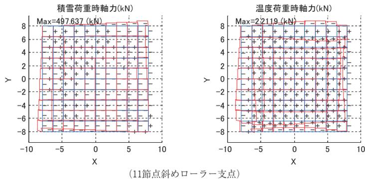
図4.20 積雪荷重時（左），温度荷重時（右）軸力
