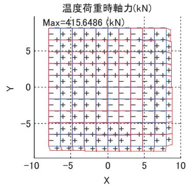
図4.6 積雪荷重時 (左), 温度荷重時 (右) 軸力
