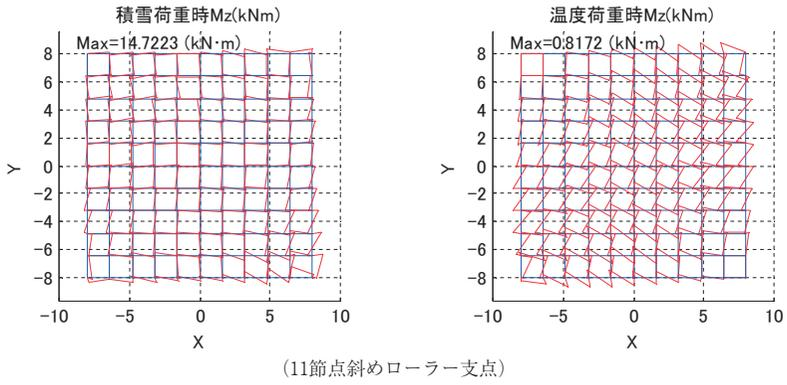
図4.21 積雪荷重時 (左), 温度荷重時 (右) Mz
