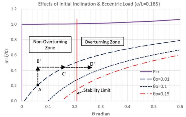
図 16 つり合い移行型の転倒（動解析）
