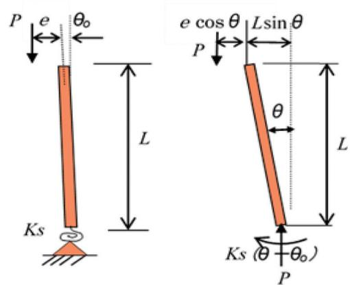
図1 杭打機の静解析構造モデル
