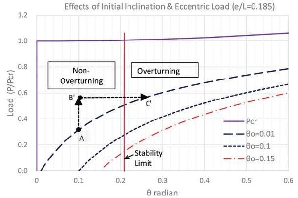
図4 つり合い移行型の転倒 ( $e/L=0.185$ )
